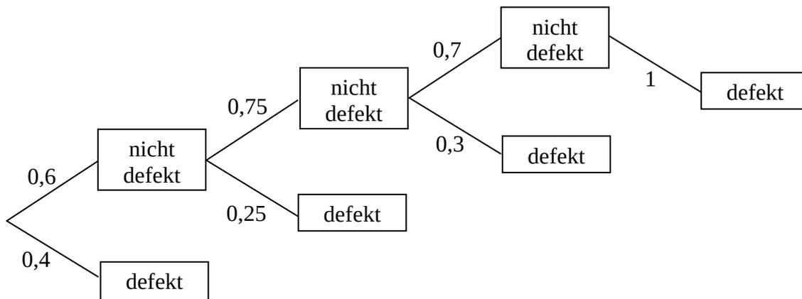
Der Übergangsgraph stellt die anteiligen Übergänge von einem ins nächste Jahr dar sowie zu dem absorbierenden Zustand „defekt“.
